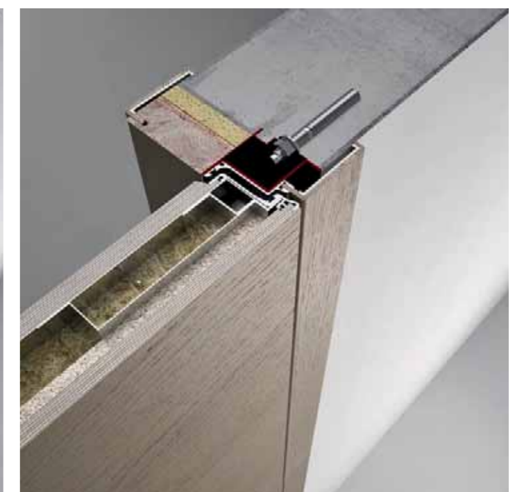
Soluzione 2 - Portone blindato a filo lato interno con mostrina, con imbotte in legno e mostrina lato esterno, da installare su murature preesistenti con controtelaio.
